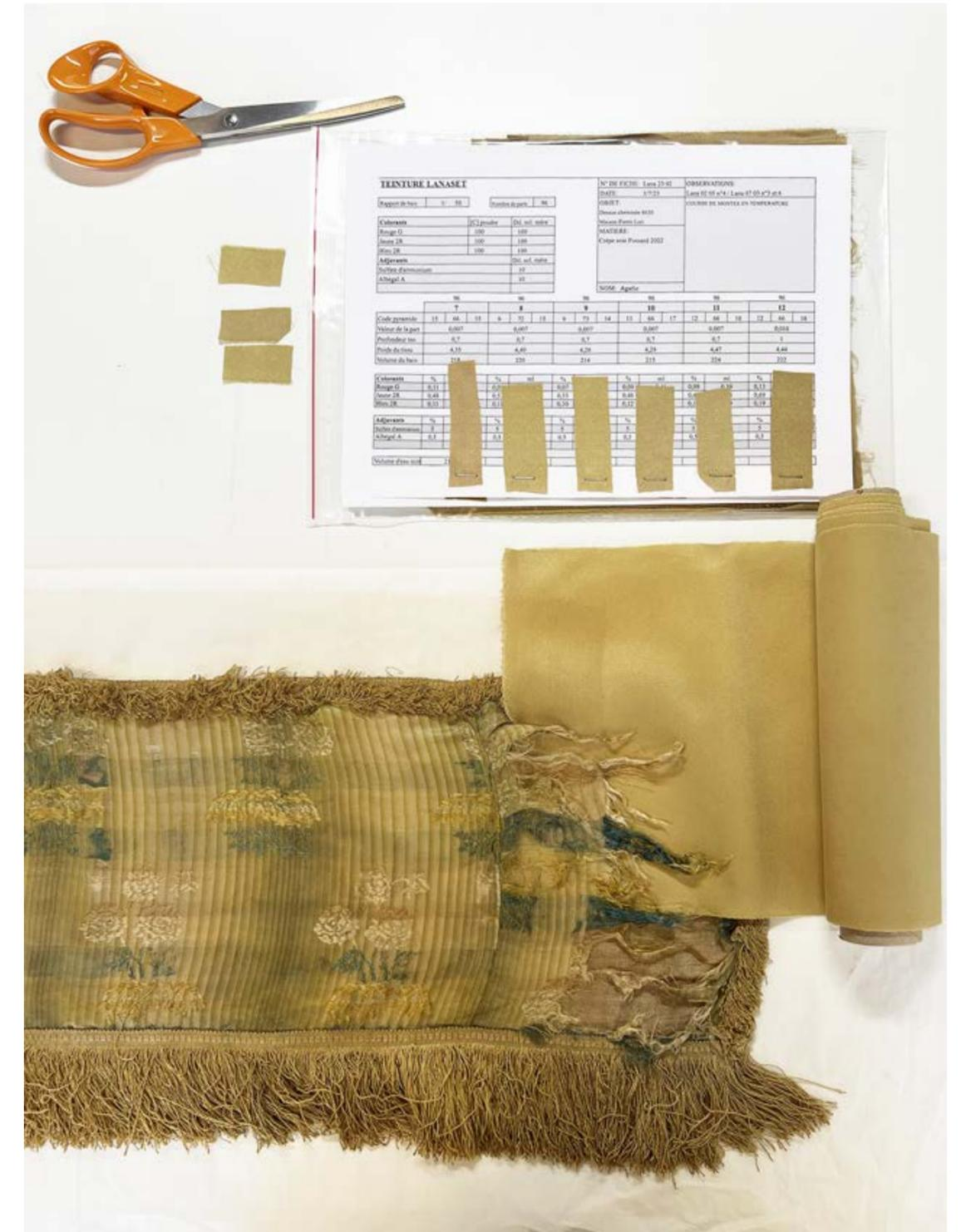
La réalisation des teintures sur mesure : pour les toiles de renfort, pour les tulles / crêpelines, pour les fils.
